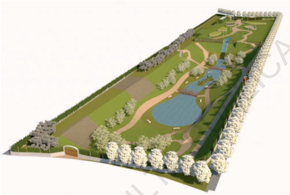
Figura 59. Concepto de diseño de un parque inundable (Caso de ejemplo: Parque Inundable Vía Parque, Alicante, España).
