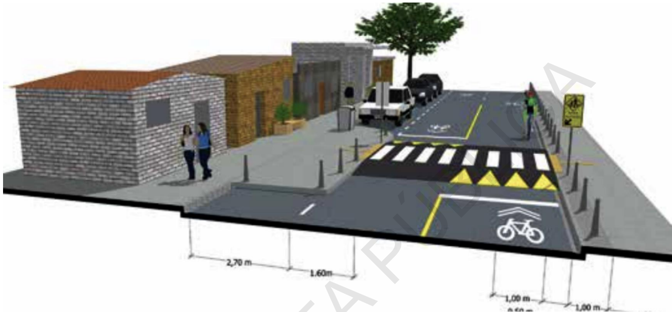
Figura 62. Ejemplo de conceptos de diseño urbano para calles completas. Caso: Calle de uso compartido con bicicletas, con diseño tipo bulevar, señalización vial y medidas de tránsito calmado.
